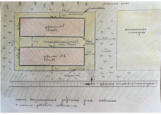
**Работы/материалы**: выемка грунта, геотекстиль, песок, трамбовка, щебень галечный, гранитный отсев, бордюр садовый, пескобетон, перемещение материалов вручную **Стоимость (за 1 дорожку)**: 67000 руб — материалы, 71800 руб работы, 16700 руб — доставка, накладные расходы. Не включает газон и освещение.
